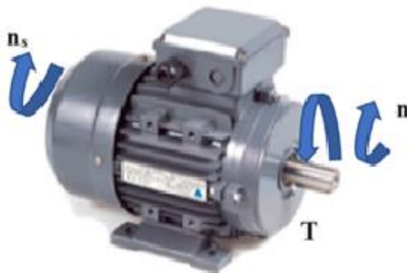
Fig.I.9 Sens de rotation de la machine asynchrone par rapport au champ tournant en fonctionnement génératrice.
