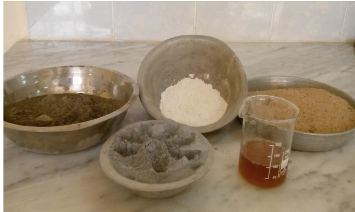
Figure3.6. Composition de mortier autoplaçant.
