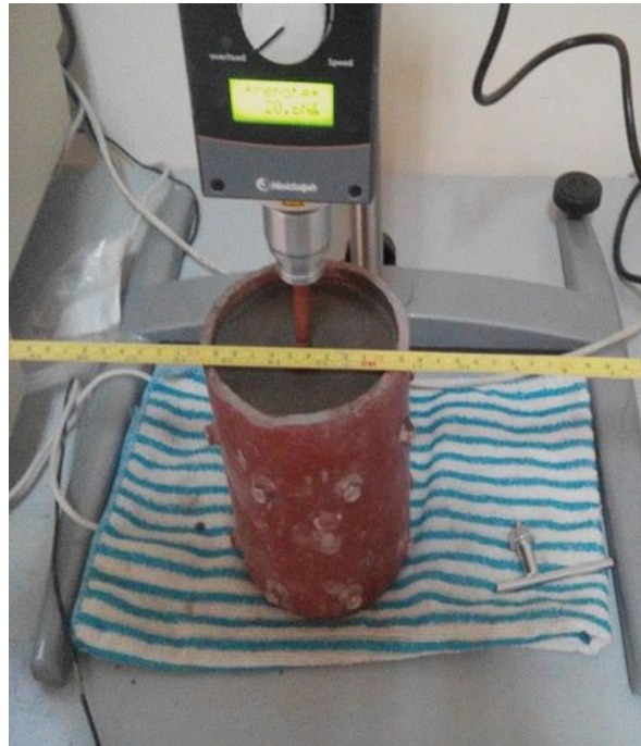
Figure 3.20. Positionnement de la pale de rhéomètre
