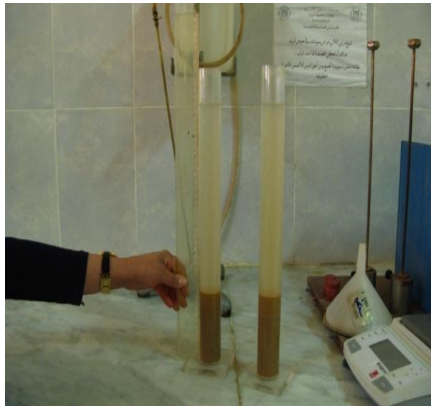
Figure 3.4. Essai de l'équivalent de sable.
