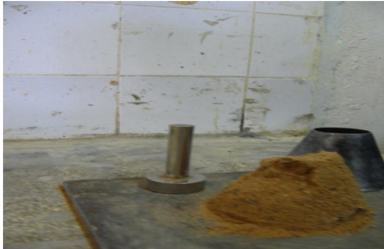
Figure 3.5. Teste de pré-séchage avec le cône et le piston.
