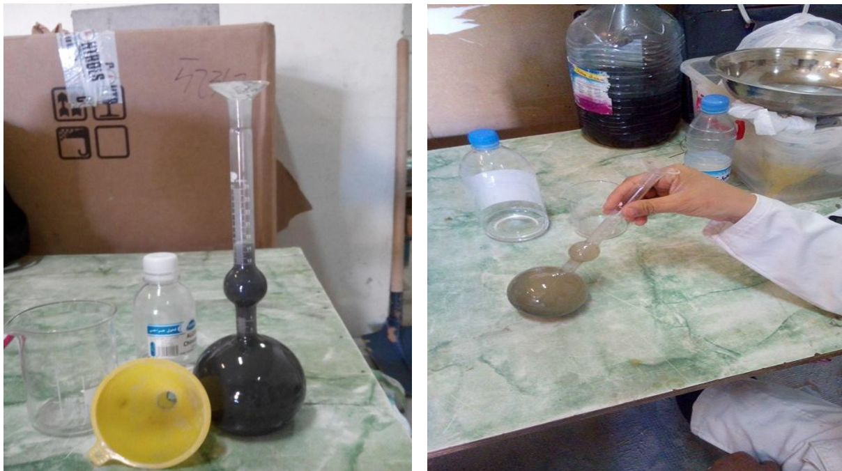
Figure3.4. Essai de la masse volumique absolue du ciment.
