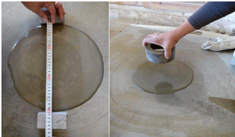
Figure 3.17. Exécution et mesure d'étalement en mini-cône
