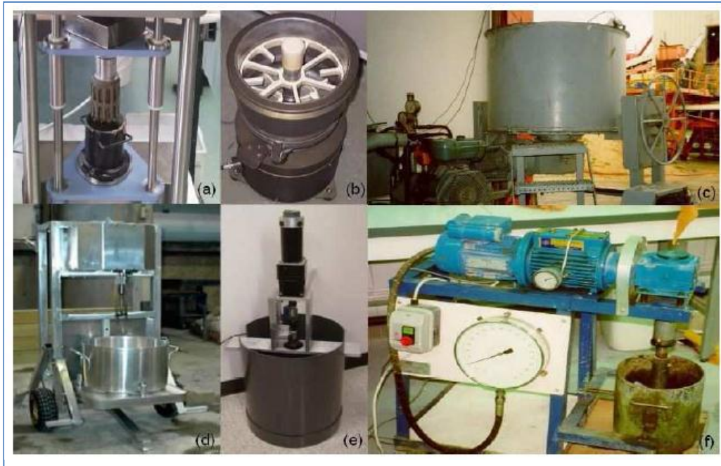
Figure 2.7. Rhéomètres à bétons existants : BML (a) ; BT Rhéom (b) ; Cemagref (c) ; IBB (d) ; ICAR ; Two point test (f)
