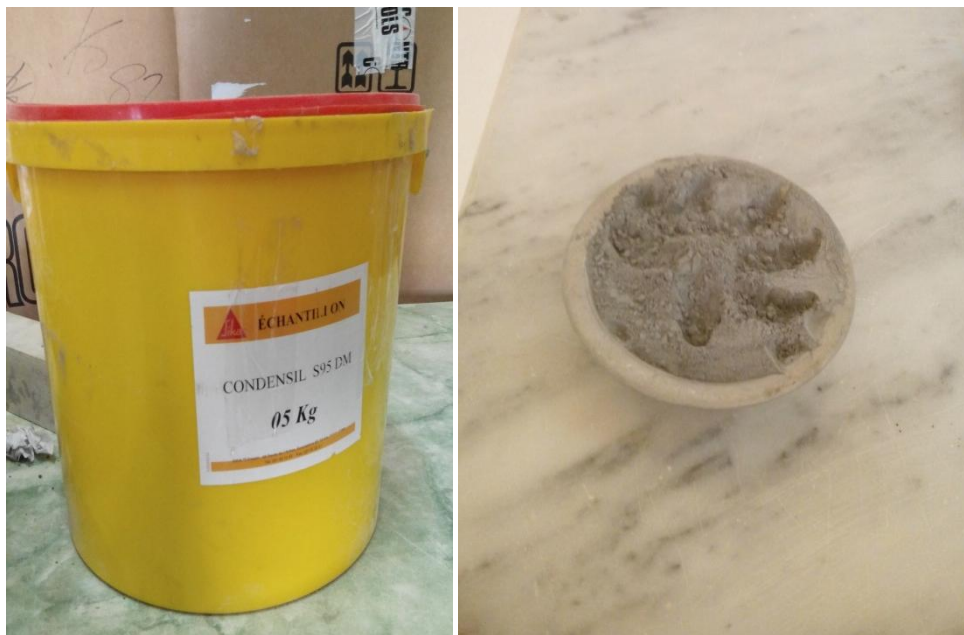
Figure 3.8. Fumée de silice.
