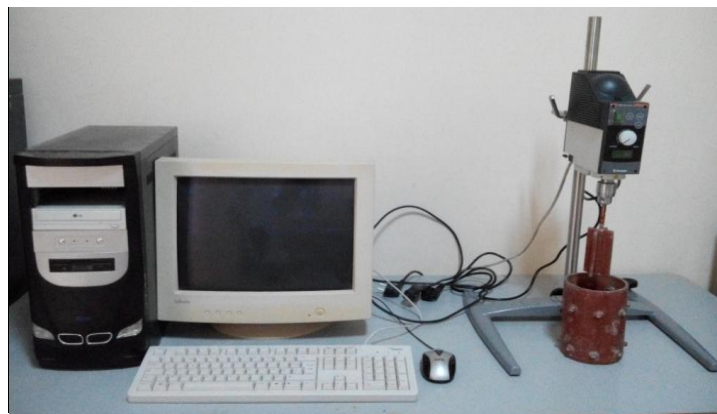
Figure 3.15. Dispositif du rhéomètre utilisé.
