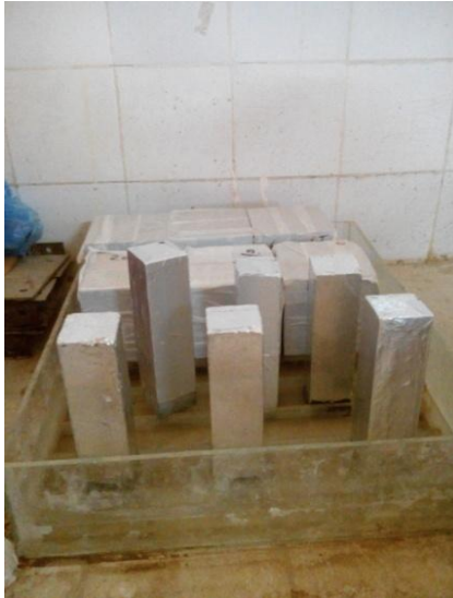
Figure3.9. Essai d'absorption d'eau par capillarité
