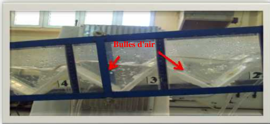
PhotoIV.10 : Ecoulement en nappe partiellement développé dans le modèle C
