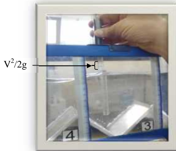
Photo IV.7 : Mesure de la vitesse avec tube de Pitot.
