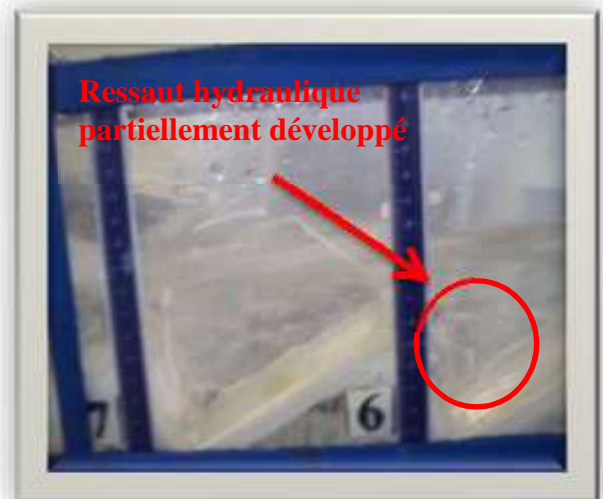
PhotoIV.9: (a) ressaut hydraulique pleinement développé pour les moyens débits (modèle B) (b) ressaut hydraulique partiellement développé pour les moyens débits (modèle B)
