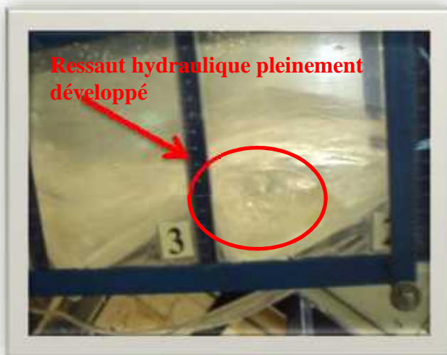
PhotoIV.9: (a) ressaut hydraulique pleinement développé pour les moyens débits (modèle B) (b) ressaut hydraulique partiellement développé pour les moyens débits (modèle B)
