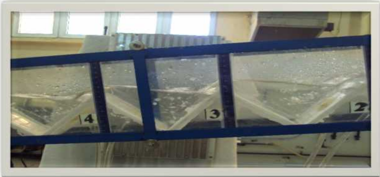
Photo IV.8 : Ecoulement en nappe sans ressaut à faible débit dans le modèle C
