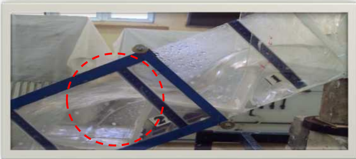
Photo IV.12: Effet de jet sur la pression (dépression) dans le modèle C.
