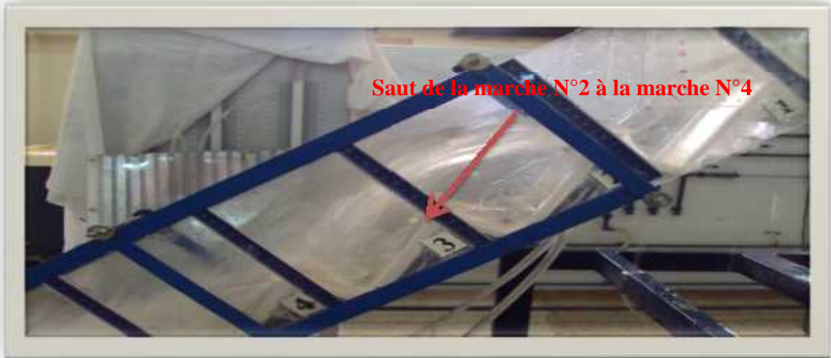
Photo IV.11 : Déflexion du jet dans le modèle B.
