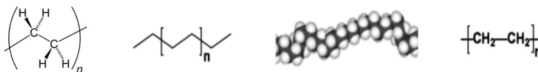
Figure 3 : Différentes représentation de la chaîne macromoléculaire du polyéthylène
