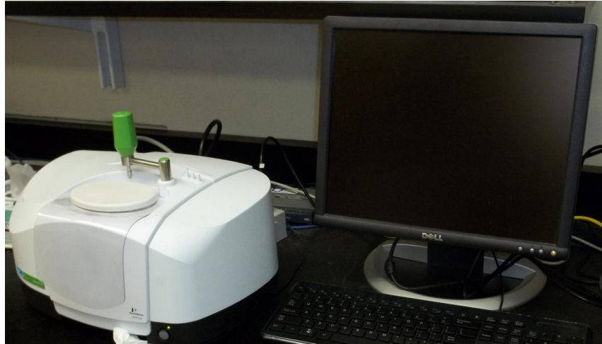
Figure 24 : Le spectromètre à transformée de Fourier Spectrum Two
