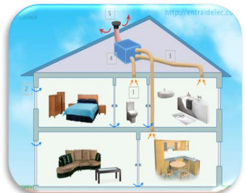
Figure 15: La ventilation mécanique contrôlée (VMC) simple flux [16]
