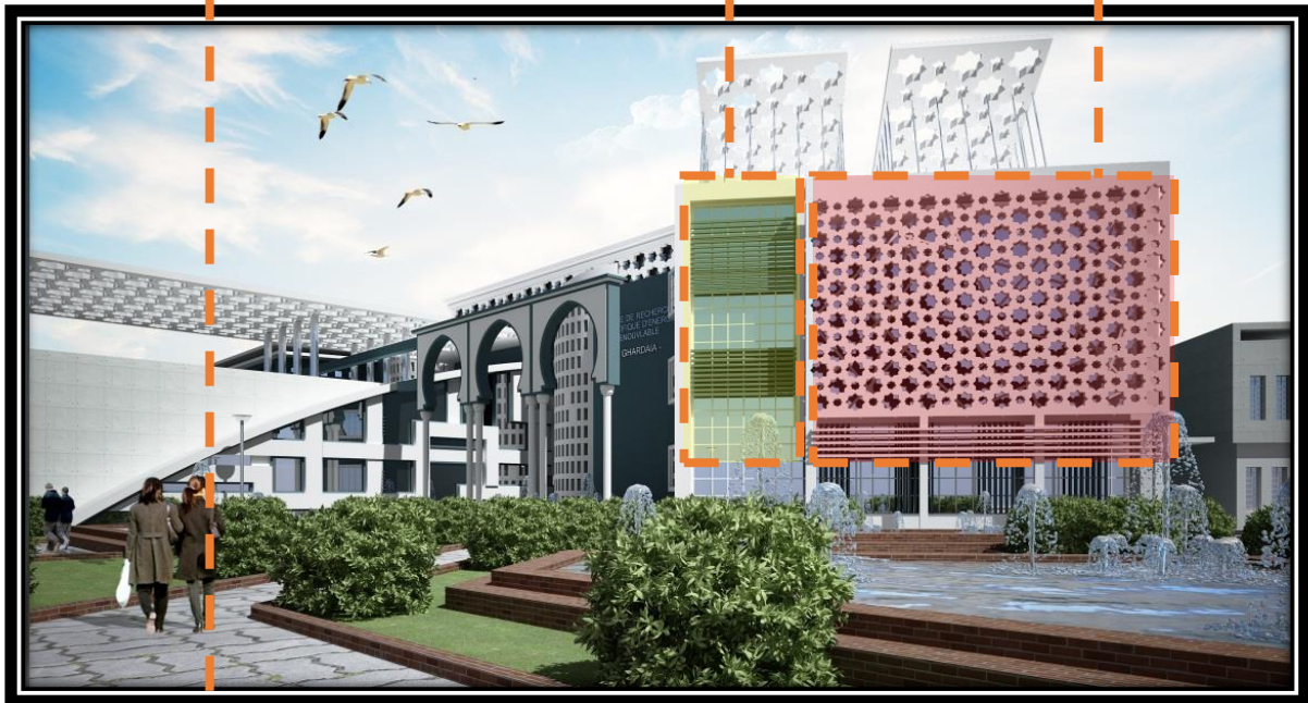
Figure 130 : utilisation des brises soleil
