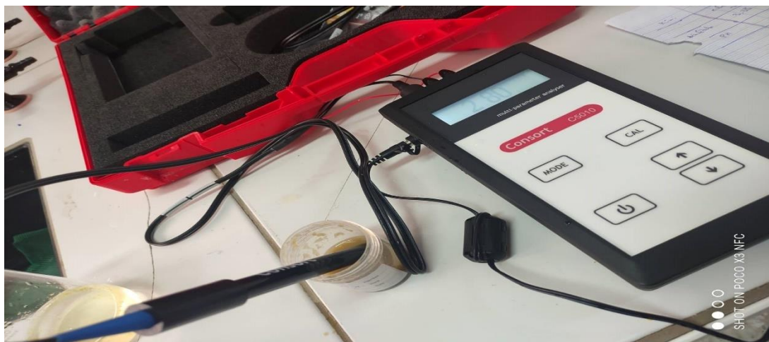
Figure 10 : mesure de conductivité électrique (photographie originale).
