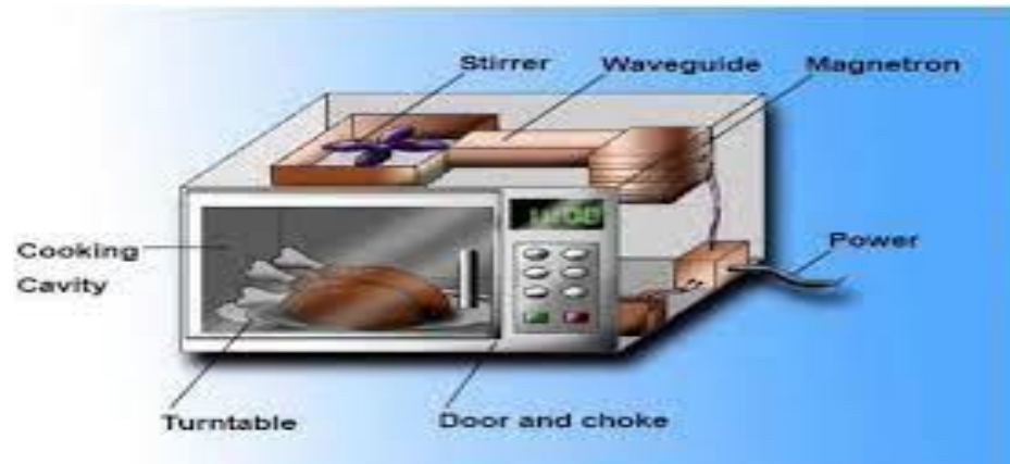
Figure 03 : Schéma d'une micro-onde (Reddam et al., 2018).
