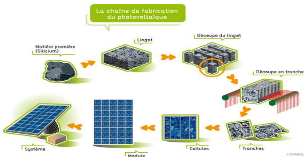
Figure I. 11 chaîne de fabrication de générateur PV
