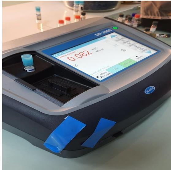
Fig31. Estimation de (\text{NO}_3) et (\text{NO}_2) par Spectrophotomètre (Original, 2025)
