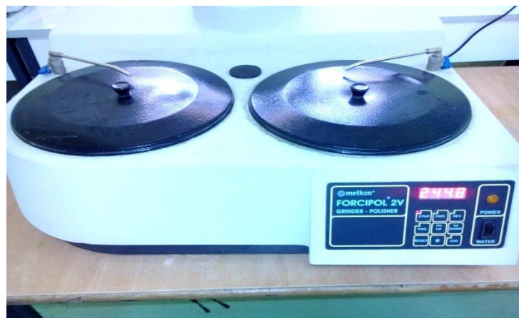
Figure II.2 : Image de polisseur à disque (FORCIPOL 2V).
