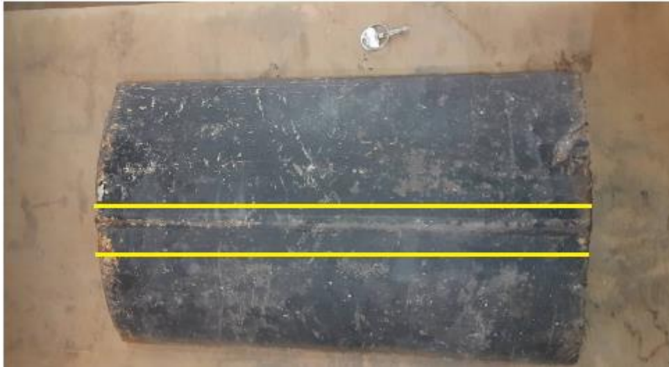
Figure II.1 : présentation du cordon de soudure de l'acier X70.
