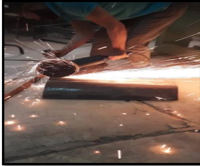
Figure II.2 : figure représente le découpage d'échantillon X70
