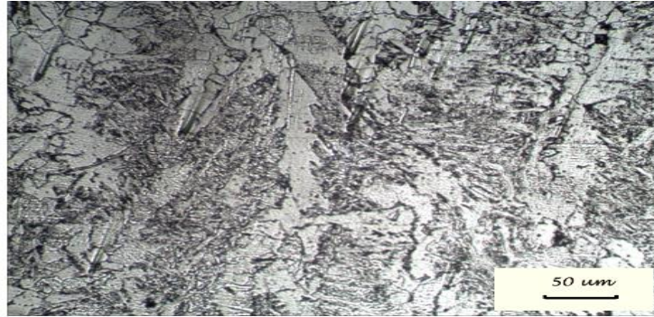
Figure III.1 : Observation microscopique l'échantillon de cordon de soudure de l'acier X70 ( traitement thermiquement à 450°C et un maintien 2 heure de temps).
