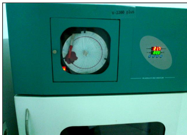
Figure n°08: L'appareil d'un système d'agitation continu pour la conservation des plaquettes (photo personnelle).
