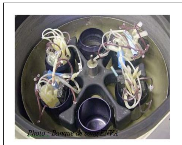
Figure 2: La centrifugeuse des poches du sang (photo personnelle)
