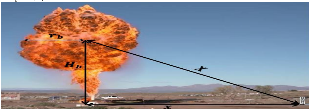
Fig. 06 : Représentation schématique de la boule de feu (HELLAS 2021)
