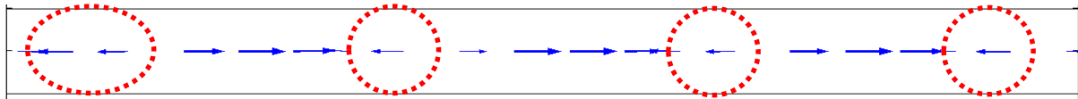
Figure.III.15 Distribution de la force de Lorentz dans l'épaisseur de peau magnétique dans le plan (XOY) responsable de la création du mouvement dans la cavité.
