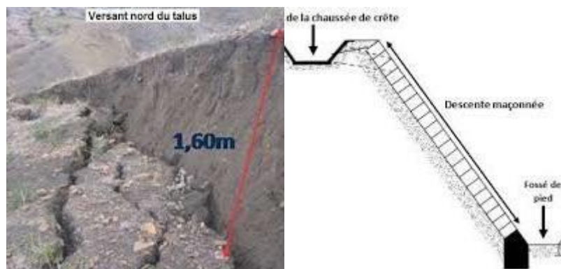
Figure.I.7 : Canalisation des écoulements sur pente pour éviter l'érosion et glissement de terrains.
