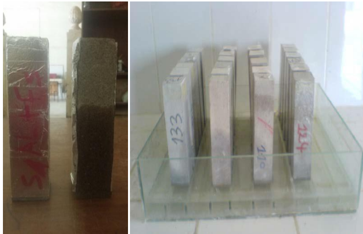
Figure. II.15. Montage expérimental utilisé dans l'essai d'absorption.
