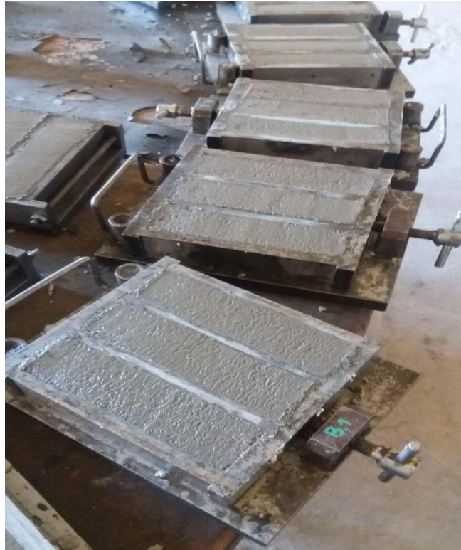
Figure. II.10: Confection des éprouvettes de béton de liège.
