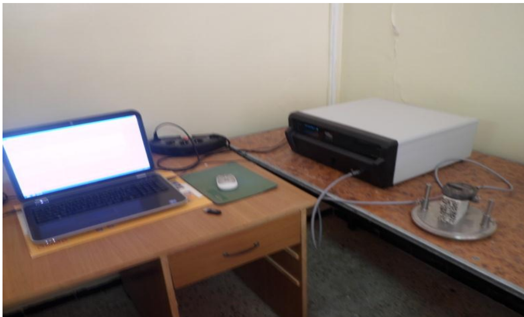
Figure. II.18. Mesure de propriétés thermique à l'aide du system «Hot Disk».
