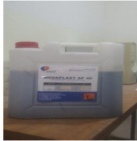
Figure. II.5 superplastifiant « Medaplast SP40 » Fabriqué en Algérie par la société GRANITEX
