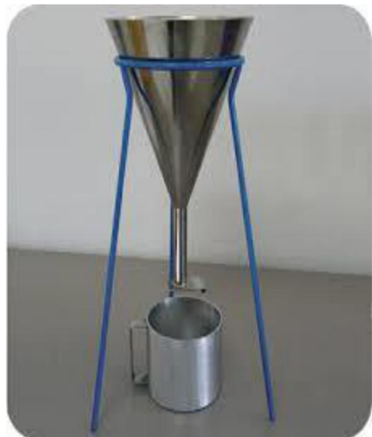
Figure. II.1. Méthode de mesure de la masse volumique absolue et apparente
