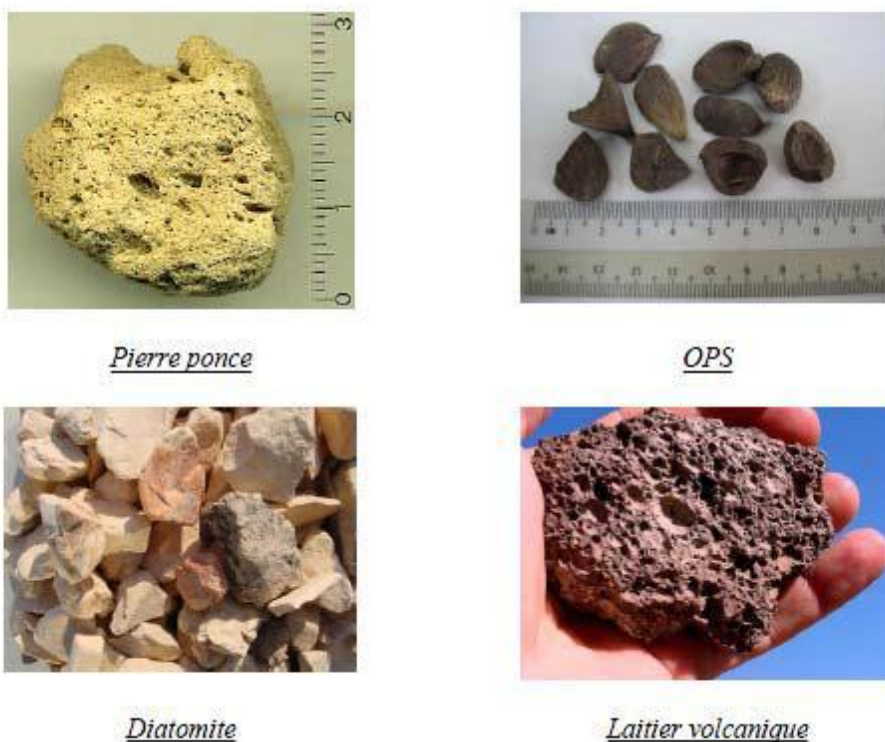
Figure I.9 : Différents granulats légers naturels ( A. Steopoe ;1970 ).
