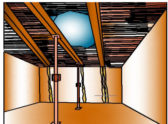
Fig. III.A. 33. étaiment du plancher
