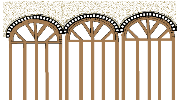
Fig. III.A.27. étalement des voûtains
