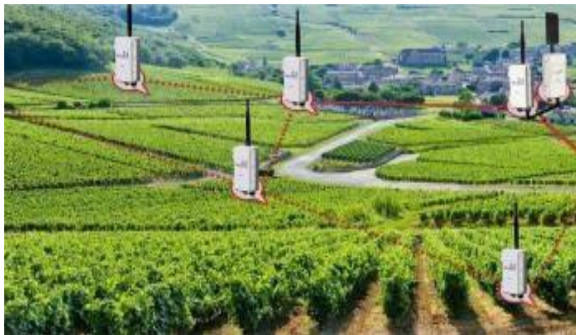
Figure 1.14 : utilisation des capteurs météo dans l'agriculture avec RCSF
