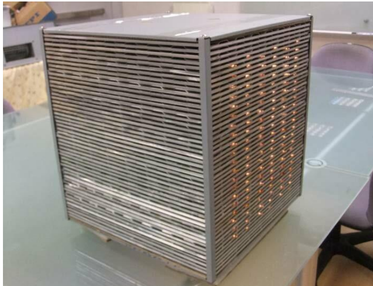
Figure II.6 : Échangeur de chaleur refroidi par air (aéro-réfrigérant).
