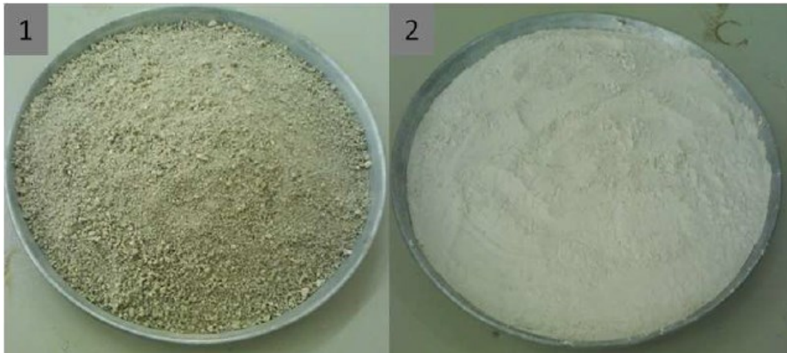
photo 11. Laitier des hauts fourneaux, (1) avant broyage ; (2) après broyage.
