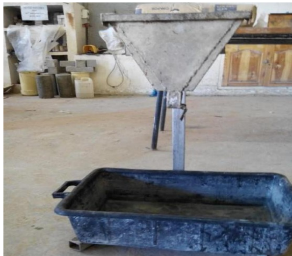
Photo 32. Exécution et mesure d'écoulement à l'entonnoir en V (V-Funnel)
