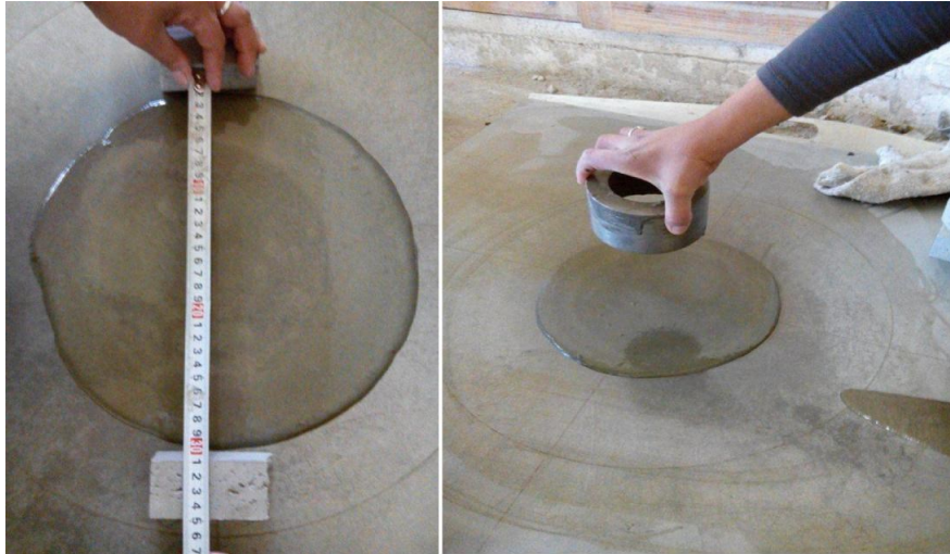
Photo 31. Exécution et mesure d'étalement au mini-cône
