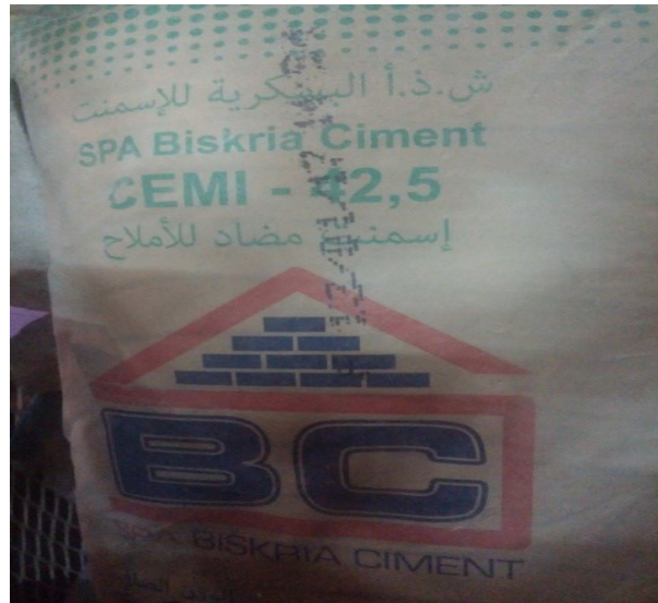
Photo 27. Ciment utilisé dans la confection des mortiers autoplaçants.
