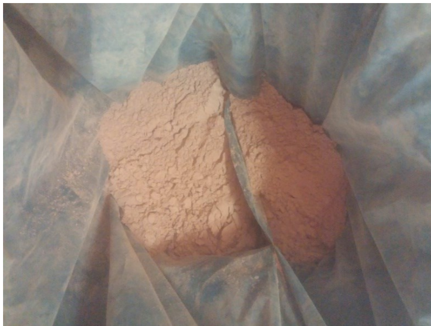
Photo 15. Déchet de brique broyés
