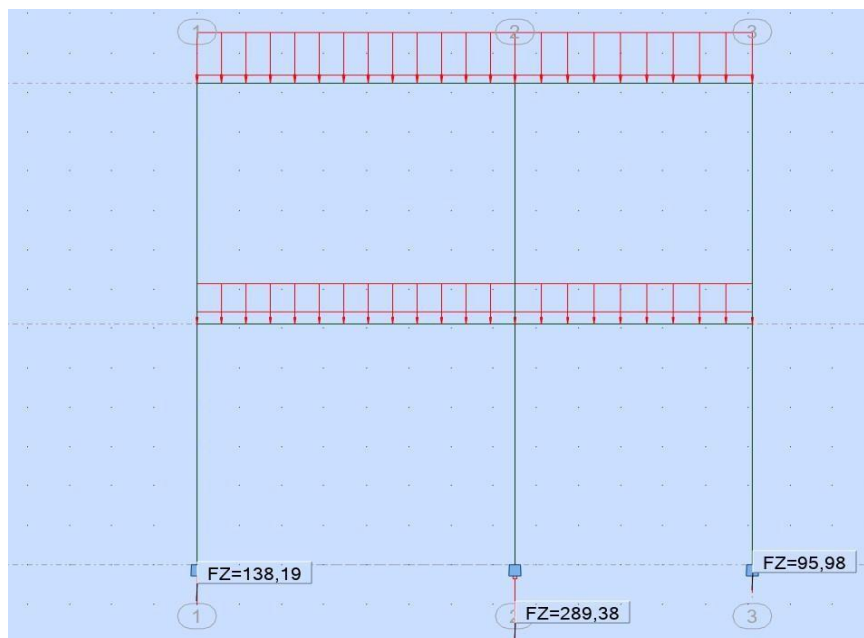
Figure 6.2 : Portique 1 : L = 6,55\text{m}
