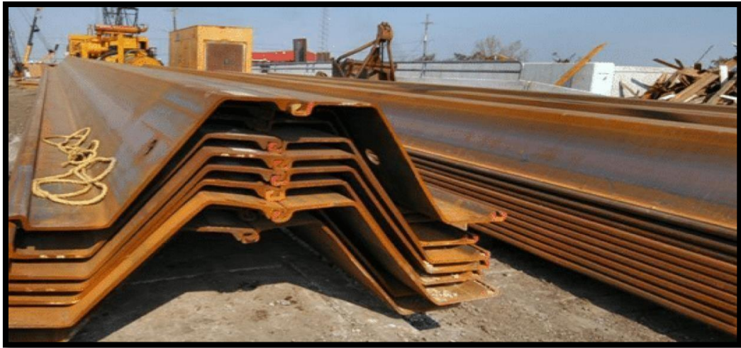
Fig I.2 : Les rideaux de palplanches métalliques
