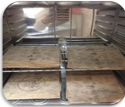
Figure 08 : Mesure de la biomasse fraîche et sèche par séchage à l'étuve.
