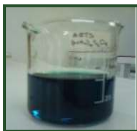
Figure 10: Solution radicalaire de ABTS •+ obtenue après ajout des ions persulfates.
