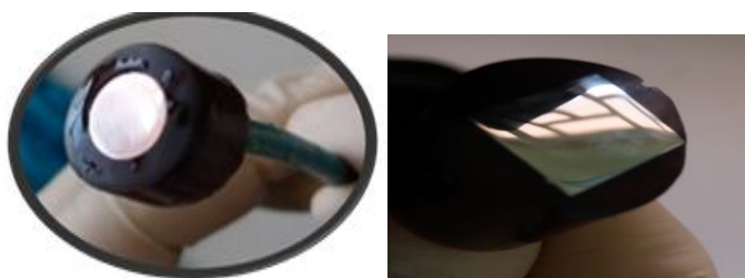
Figure II.3: Schéma de l'électrode de travail (cuivre et l'acier).
