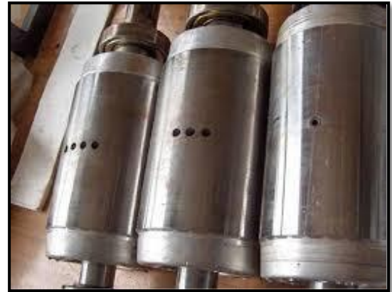
Figure I.7 Défaut de rupture des barres de rotor [3], [7]
