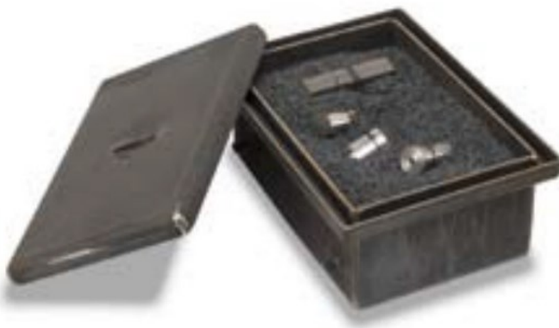
Figure 1.3 : Caisse où les pièces à borurer sont enfournées dans la poudre de boruration
