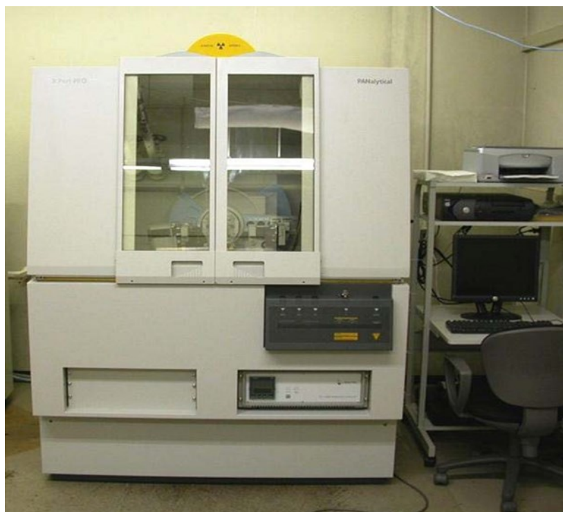
Figure 2.9: Diffractomètre de type "X'PERT-PRO".
