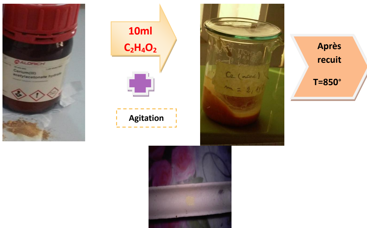
Figure III.1. La méthode de préparation de l'oxyde de Cérium
