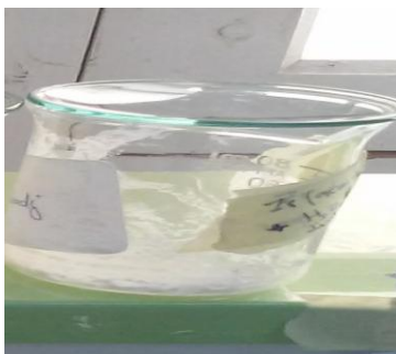
Figure III.15 : la solution de précurseur de Zr dans acide acétique +5ml l'eau distillée après un jour.
