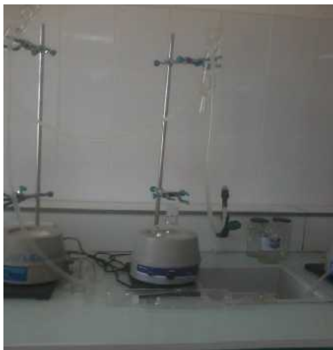
Figure 33 : Montage d'hydrodistillation par Clevenger
