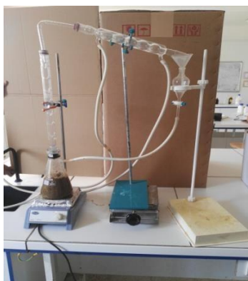
Figure 15 : Montage du dispositif d'hydrodistillation.
