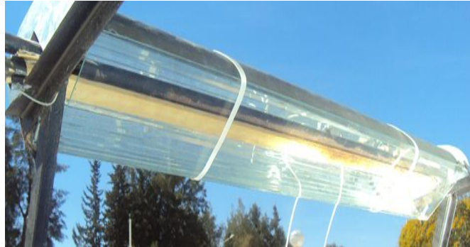
FigV.32 : l'emplacement du 1 thermocouple au milieu de l'absorbeur 1 qui est isolé par le bois et le deuxième au milieu de l'absorbeur 2
