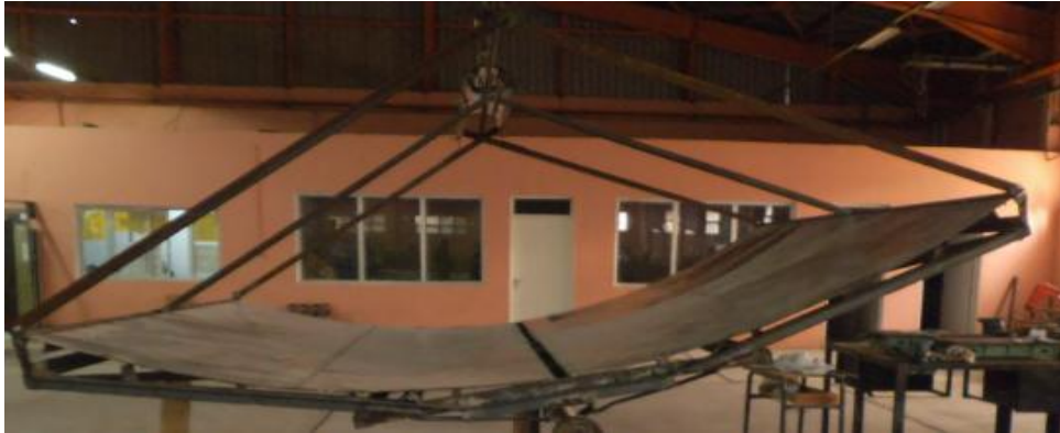
Fig V.17: Réalisation du foyer avec son support
