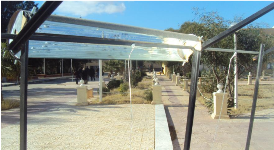
FigV.21 : l'absorbeur est une barre de 2 m séparée au milieu
