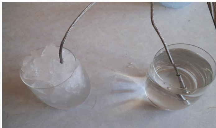
Fig V.26: les deux soudures sont mises dans les deux sources (source froid, source chaude).
