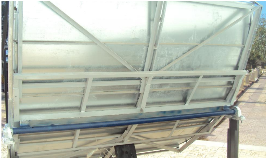
Fig V.15 : la face arrière de la surface réfléchissante avec les cornières de renforcement
