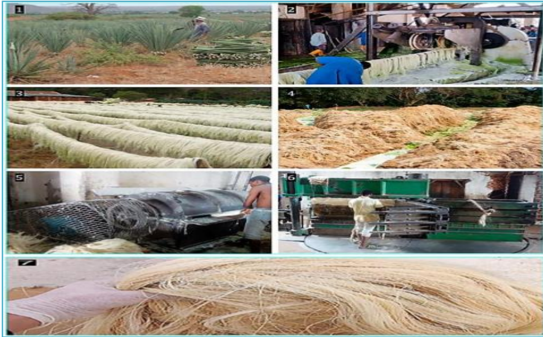
Figure I.5. Processus principales de production des fibres de sisal[22].
