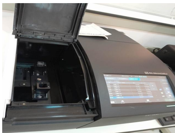
Figure n°38 : lespectrophotomètre utilisé dans l'expérimentation (photographie prise au laboratoire).
