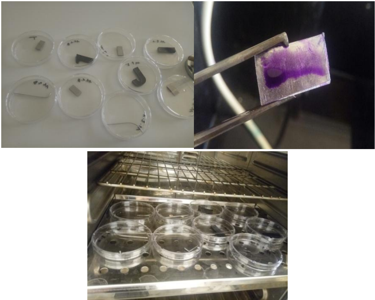
Figure N°18: les surfaces acier inoxydable,titanium et epoxy.(Photographie prise au laboratoire).
