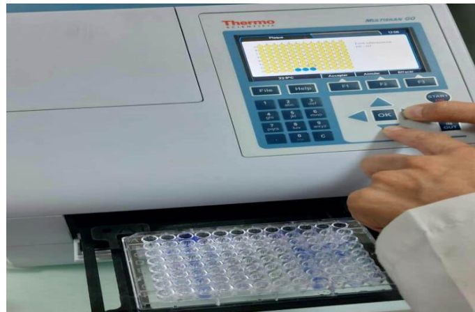
Figure N° 17: unspectrophotomètre lecteur de microplaque (photographie prise au laboratoire).
