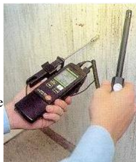
Figure 9:6 Thermomètre de contact et mesure de température ambiante Source www.energieplus.com
