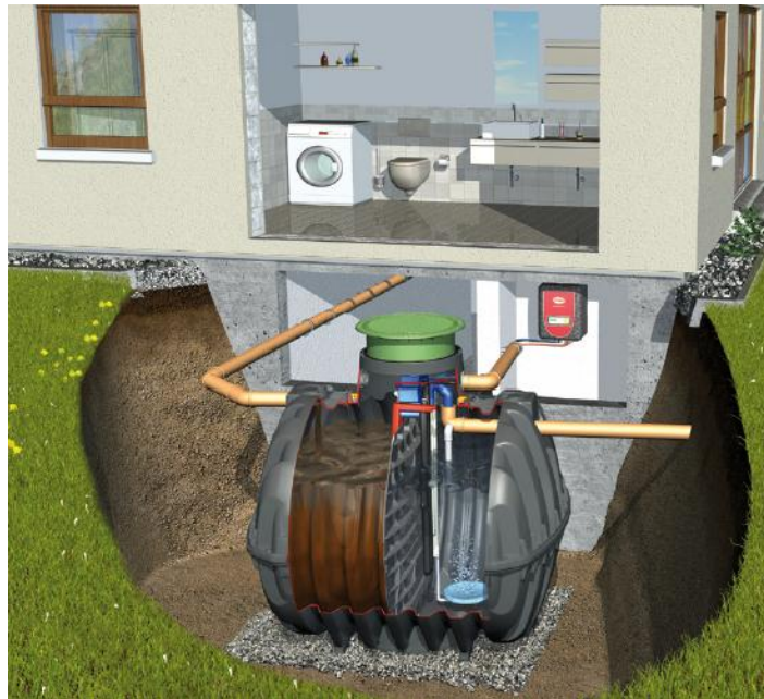
Figure 6:44 Schéma de l'épuration Source : www.graf.fr
