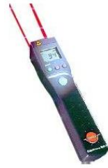
Figure 9:7 Thermomètre de surface à infrarouge Source www.energieplus.com
