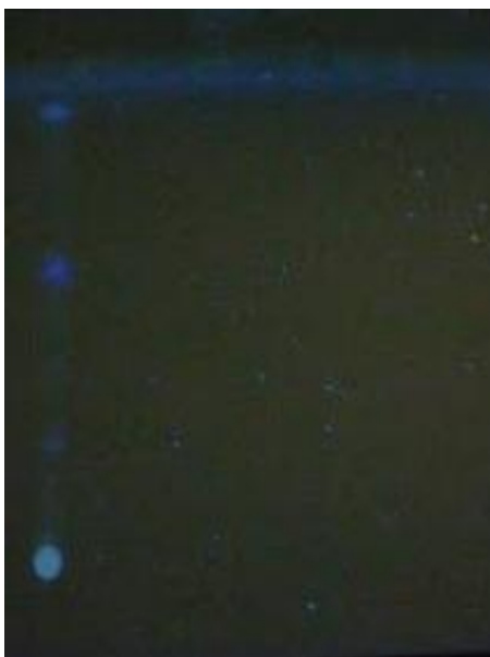
Figure 12 : Photo de la plaque CCM analytique monodimensionnelle de l'extrait hydrométhanolique des racines de Pithuranthos scoparius sous lampe UV (366nm).
