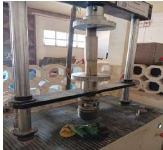
Figure II.30 : Démoulage du moule cylindrique
