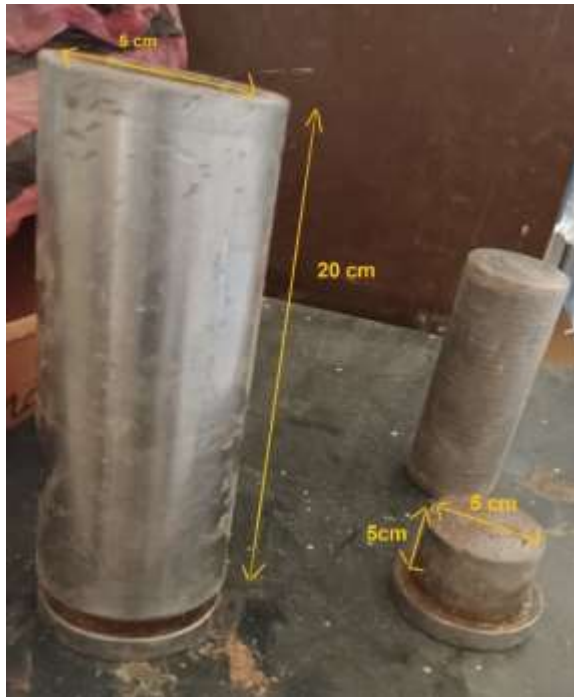
Figure.II.6 : Moule utilisé dans le compactage
