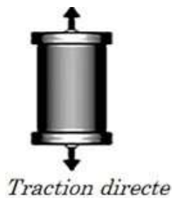
Figure II.9 : Modes de chargement permettant de soumettre une éprouvette à une contrainte de traction
