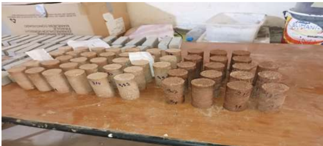
Figure.III.2 : Les échantillons traités [argile + sable + chaux +Sisal] qui ont été testés lors de l'étude
