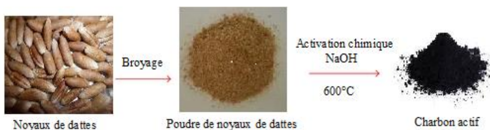
Figure (III-2): Représentation du processus de préparation du charbon actif.
