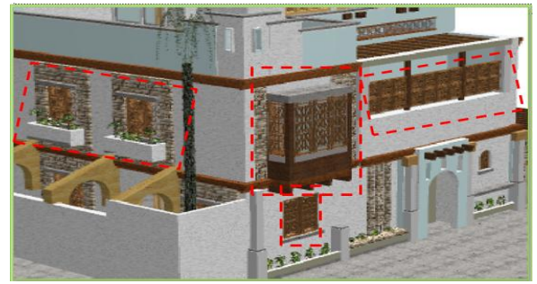
Figure VII- 25: Protection en moucharabieh, source : auteur
