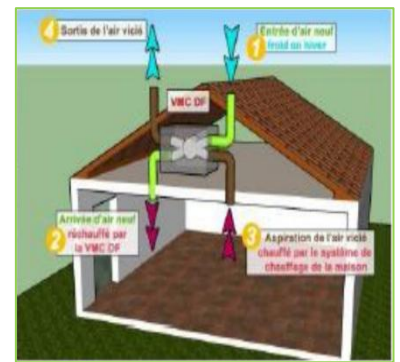
Figure III- 6: Ventilation mécanique à double flux. Source : Mémoire de Magister : Conception d'un Habitat Ecologique, Durable et Economique, Tlemcen, Mars 2009
