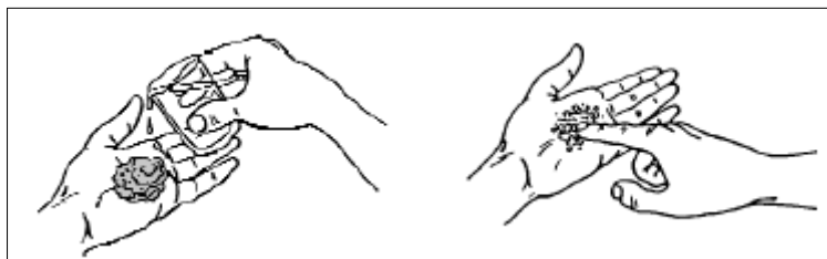
Figure II.10: Manipulation Odeur de l'adobe source : guide adobe construction parasismique
