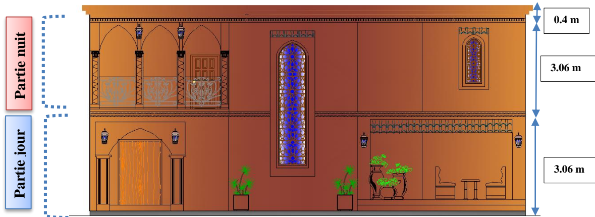
Figure III.123 : La façade principale (échelle 500) source : auteur
