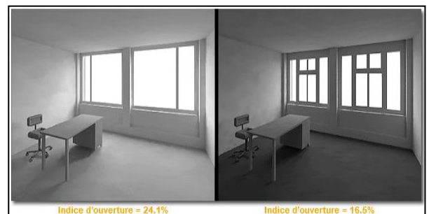
Figure 44: Influence des menuiseries sur la surface d'ouverture (Vue l'intérieur). Source : EPFL-ENAC 2007-UE-M : Espace et lumière: Le projet d'éclairage
