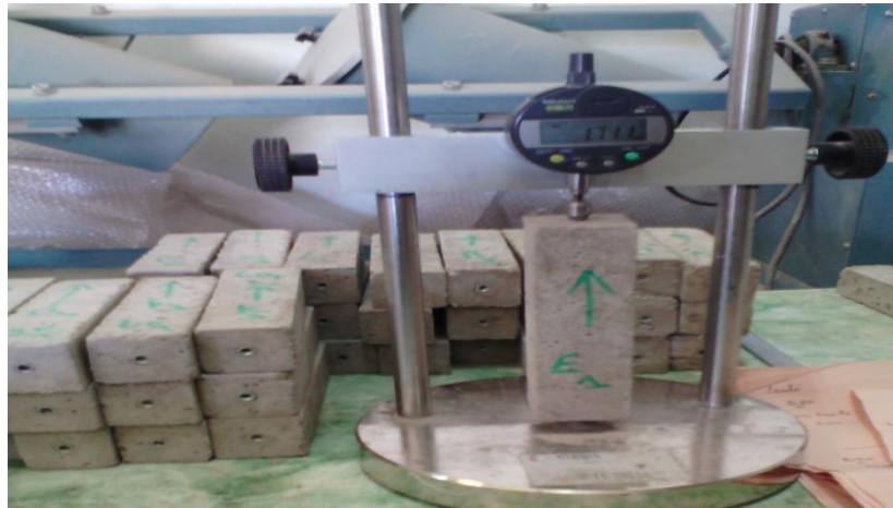
Photo n°05 : Appareil de mesure du retrait
