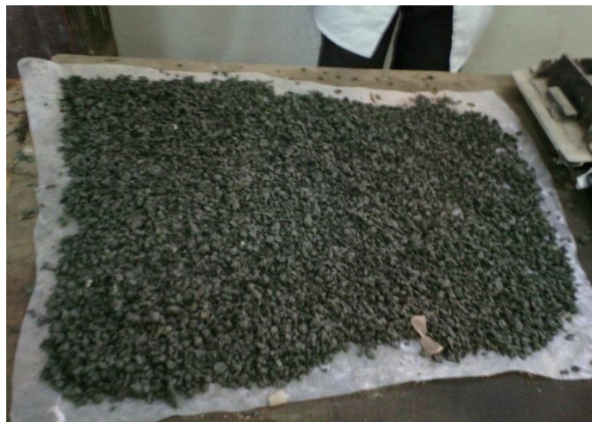
Photos n° 2 : copeaux de bois après traitement
