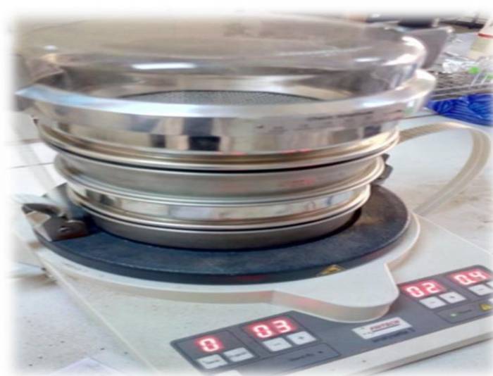
Figure16. Tamisage du sol.
