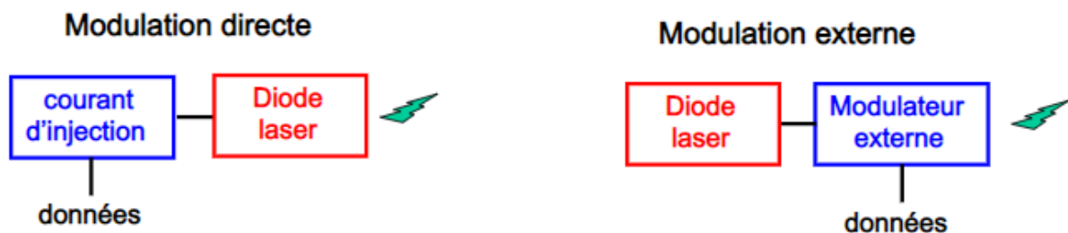
Figure I.13: Les deux méthodes de la modulation optique
