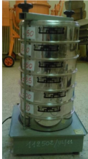
Fig(II.3) : Série de tamis et agitateur utilisés pour l'analyse granulométrique
