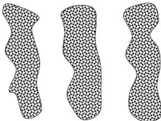
Fig I.7: Représentation de la structure du silicium macroporeux (des pores ~ 0,1 à 1 \mu\text{m} )
