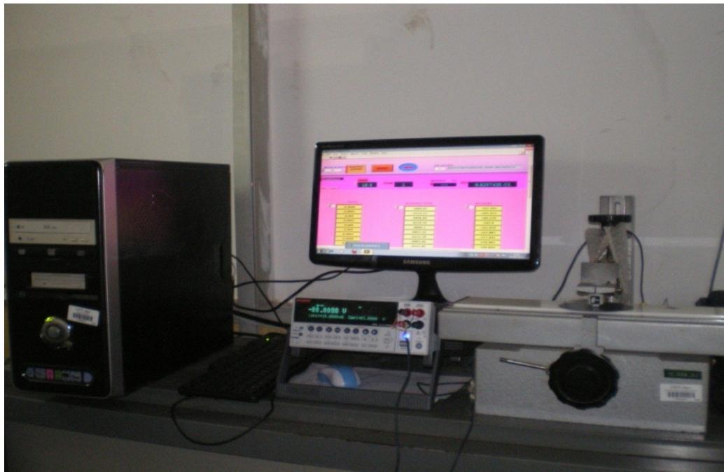
Fig.IV .26 : Mesure de la résistivité par la méthode des pointes alignées :
