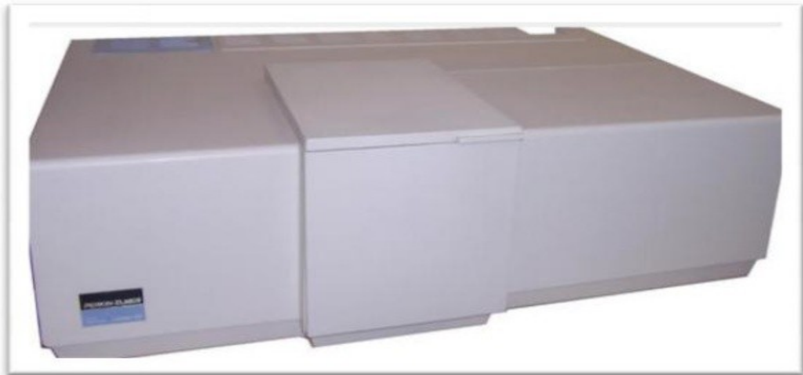
Figure III.7 Spectroscopie UV-VIS-IR « Lamda 900 de Perkin Elmer » ; (LMOPS)-
