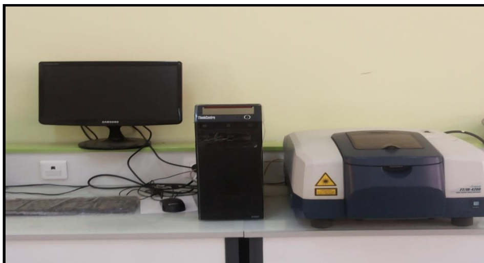
Figure III.4. Spectromètre infrarouge (laboratoire de physicochimie des matériaux)
