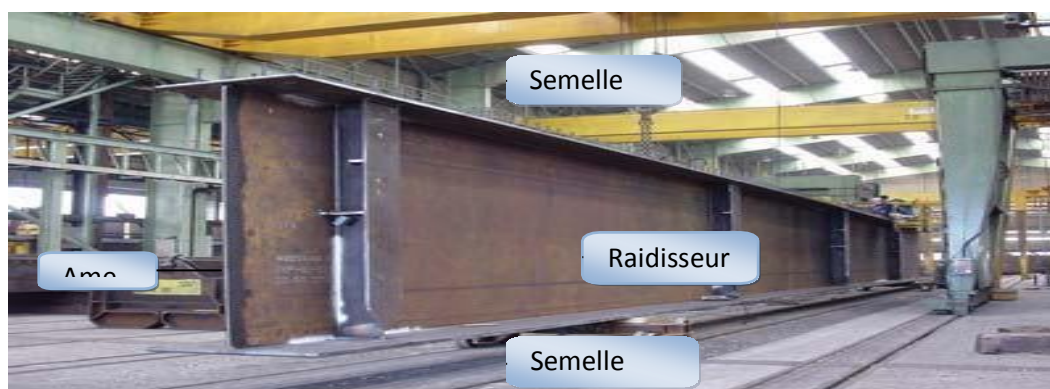
Figure I-8: Poutre PRS à l'atelier
