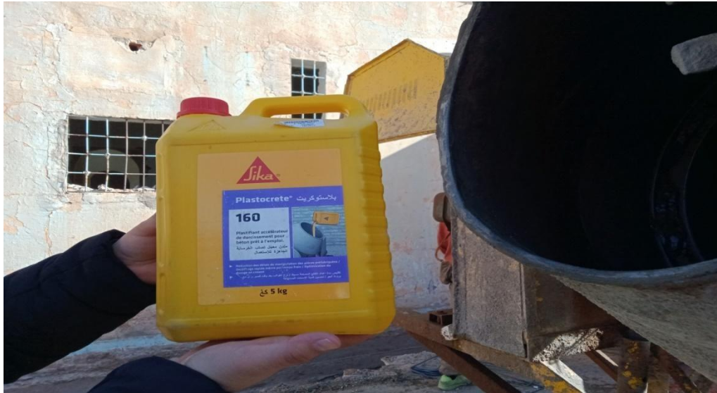
Figure IV-15 : utilisant l'adjuvant pour accélérer la durcissement de béton armée
