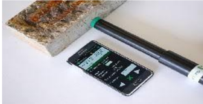
Figure II-11 : capteur pour mesurer le potentiel de corrosion
