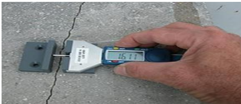
Figure II-5 : JAUGE –GINGER CEBTP (Fissuromètre digital)
