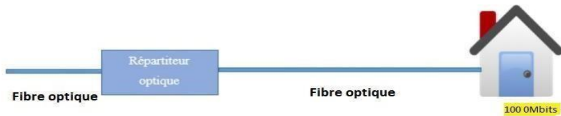
Fig.II.5 : Structure d'un réseau FTTH [24].
