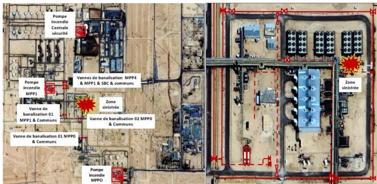
Figure 26 : Banalisation du réseau anti-incendie zone centre
