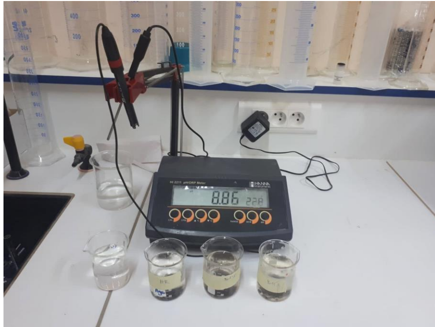
Figure 17: mesure du pH (Originale, 2018).
