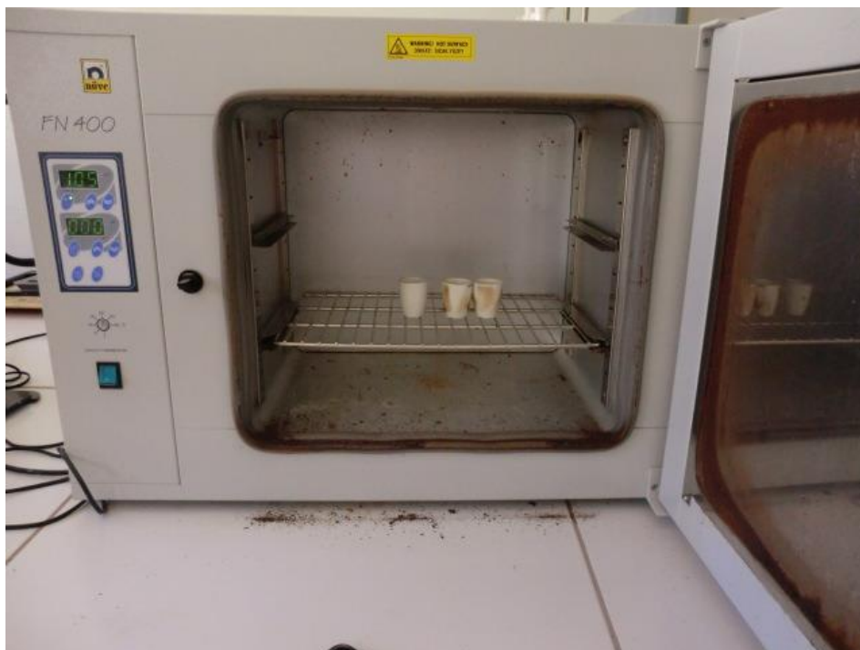
Figure 12: La déshydratation des échantillons dans l'étuve ( Originale, 2018 ).
