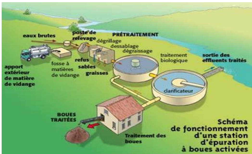
Figure 1: Schéma de fonctionnement d'une station d'épuration (AMIR 2005).
