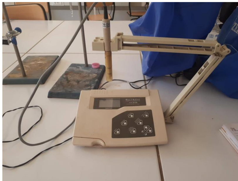
Figure18: Mesure de la conductivité (Originale, 2018).
